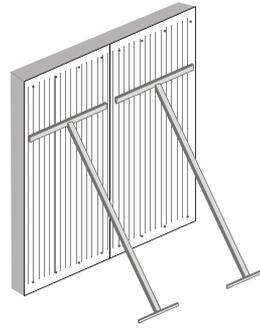
Simplísima se aplica directamente sobre la estructura portante (acero galvanizado y madera), con las distancias de montantes recomendadas: no requiere de base de apoyo de placa de madera o similar.
