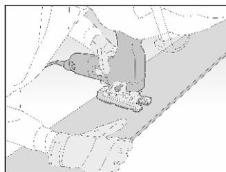
После установки последней доски под окном приложите отлив (не монтируя его) и отметьте расположение отлива на доске. Переверните доску и начертите контур подоконника на задней части доски. Оставьте зазор 10 мм между отливом и доской для вентиляции.
