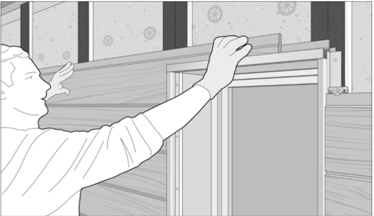
Trabalhe no sentido ascendente até à janela. Quando alcançar a tira superior, trace o contorno do topo da janela na parte traseira da tira e corte-a com o tico-tico. Certifique-se de que a tira na parte superior da janela fica alinhada com as outras tiras ao longo da linha e fixe-a com um grampo.
