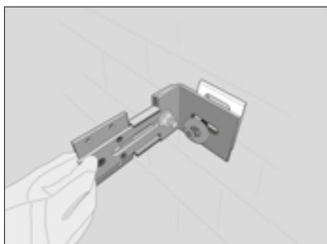
Se for necessário mais isolamento ou a parede for muito irregular, podem ser usados suportes reguláveis. Peça detalhes ao seu fornecedor.
