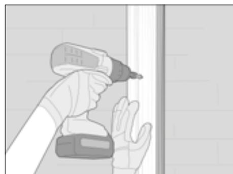
Se a parede estiver plana e se não for necessário isolamento, também não são necessárias ripas horizontais (veja o próximo passo).
