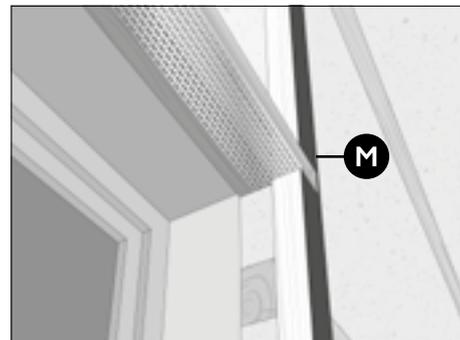
Para manter a fachada livre de ratos, aves, etc., instale os perfis de ventilação na parte inferior da fachada e acima das janelas e portas. Certifique-se de que qualquer espaço superior a 25 mm fica protegido.
