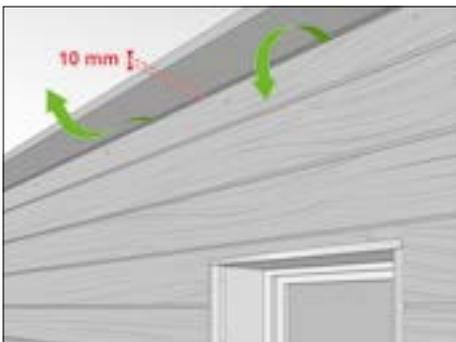
Corte a parte superior da última tira na direção longitudinal até a altura correta usando a serra, certificando-se de que mantém no mínimo um intervalo de 10 mm no topo da fachada.
