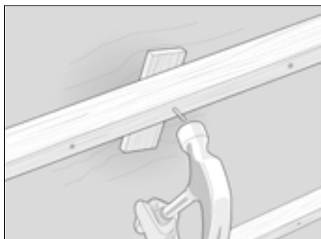
Se a parede for irregular, use calços entre a parede e a ripa para garantir que a ripa fica nivelada.
