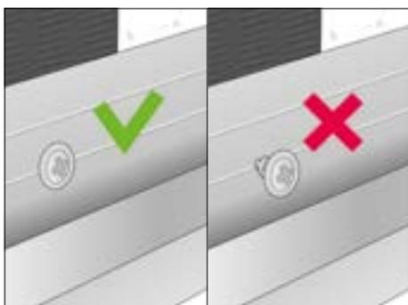
Use parafusos de aço inoxidável para fixar o perfil. Certifique-se de que todos os parafusos estão nivelados com a superfície do perfil.
