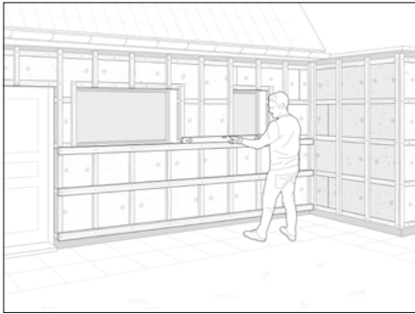
Installare un altro strato di listelli orizzontali sopra le listellature verticali.
