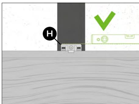
Avvitare la clip in posizione utilizzando la vite corrispondente (fornita con le clip) per assicurarsi che rimanga premuta saldamente sulla doga e sia in piano con essa. Se necessario, inclinare leggermente la vite, in modo da spingere verso il basso la clip quando è fissata.
