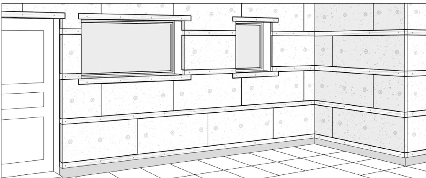
Fissare l'isolante utilizzando i fissaggi appositi. Accertarsi che l'isolante sia pressato saldamente contro la parete e che non vi siano spazi vuoti.
