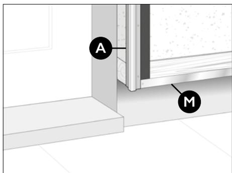
Accertarsi che la parte inferiore del profilo angolare sia a filo con la griglia di ventilazione.
