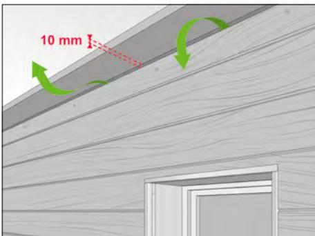
Tagliare la parte superiore dell'ultima doga in direzione longitudinale all'altezza corretta utilizzando la sega, avendo cura di mantenere una fessura minima di 10 mm nella parte superiore della facciata.
