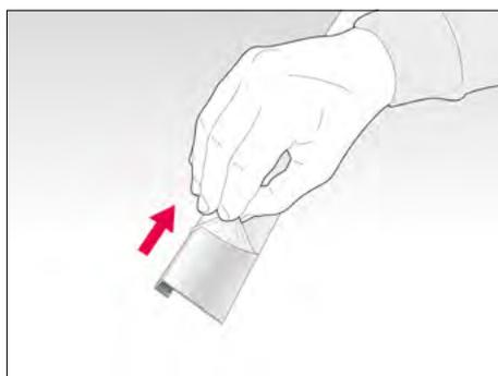
Rimuovere la pellicola protettiva dai profili prima dell'installazione. Le frecce sulla pellicola protettiva sono irrilevanti quando si installa il rivestimento
