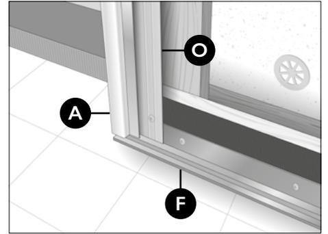
Installare il profilo di supporto orizzontalmente e il profilo di partenza in posizione verticale.
