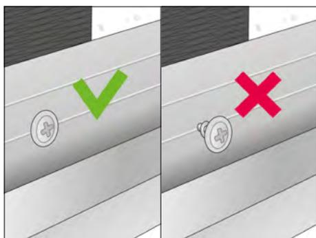
Fissare il profilo con viti in acciaio inox. Assicurarsi che tutte le viti siano a filo con la superficie del profilo.
