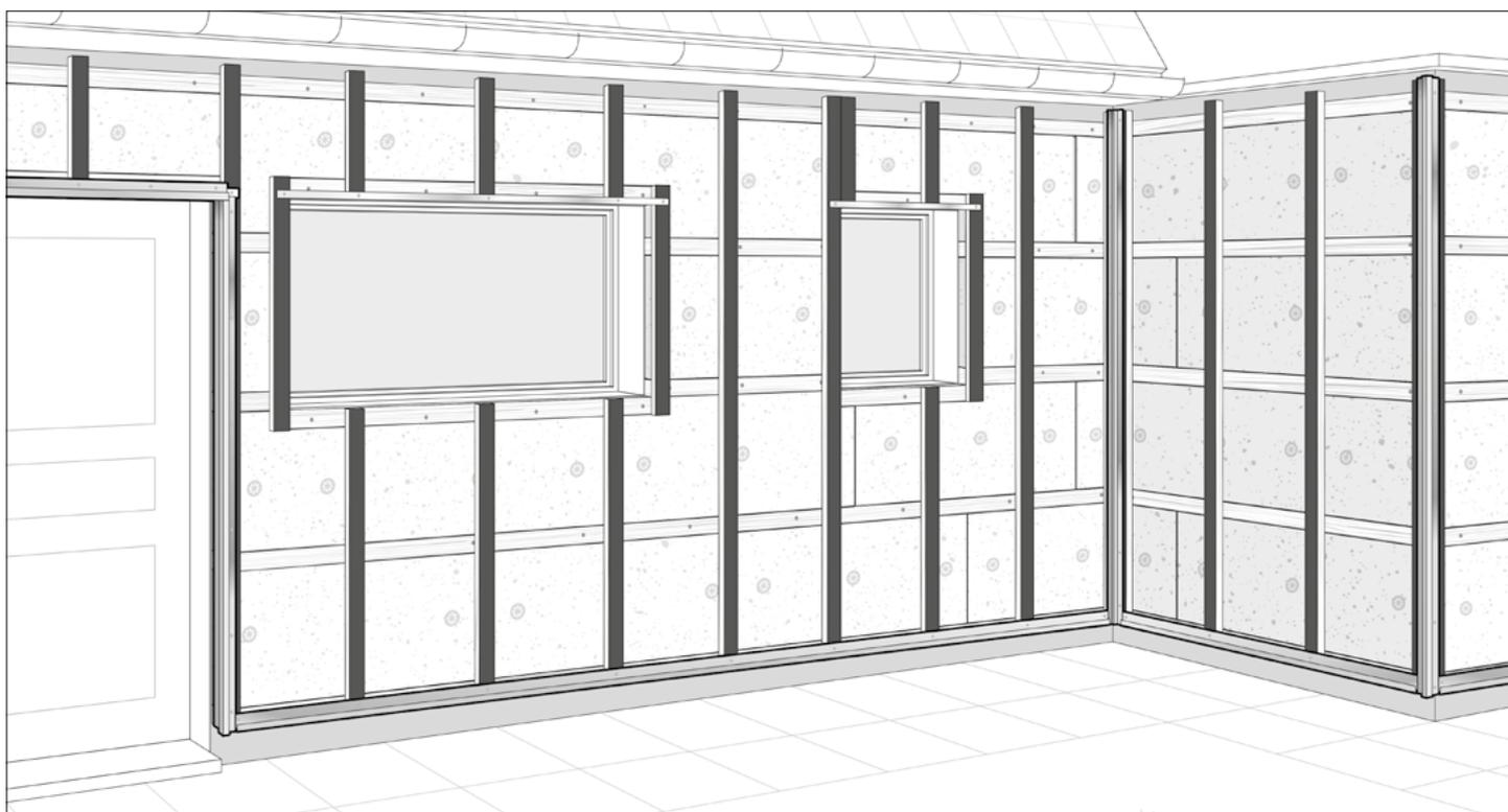
Prima di installare il rivestimento Cedral, verificare che il profilo di partenza sia orizzontale e che sia posto ovunque alla stessa altezza. Verificare inoltre che il flusso d'aria verticale non sia ostruito.
