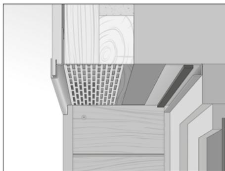
Misurare la profondità della finestra, tenendo conto di una fessura di 25 mm per la ventilazione, rispetto al profilo di rifinitura e tagliare una doga in direzione longitudinale per adattarla. Se la profondità lo richiede, possono essere utilizzate più doghe.
