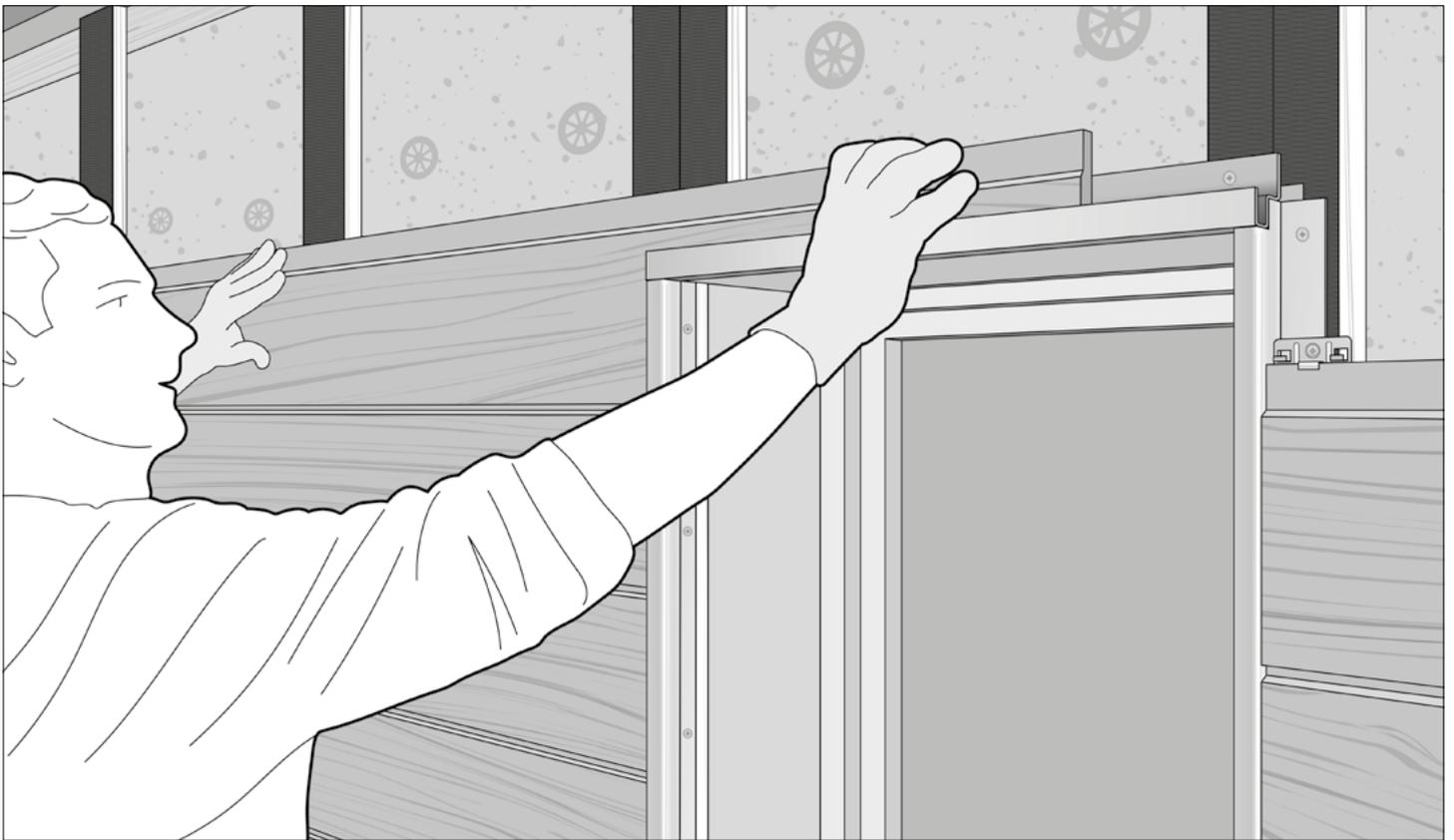
Lavora fino alla finestra. Quando si raggiunge la doga superiore, tracciare il contorno della parte superiore della finestra sul retro della doga, e tagliarlo con il seghetto. Accertarsi che la doga nella parte superiore della finestra sia allineata con le altre doghe e poi fissarla con una vite.
