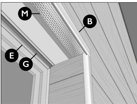
Ora misurare, tagliare e installare il profilo di finitura con il nastro espanso nella parte superiore dell'apertura della finestra come spiegato sopra.
