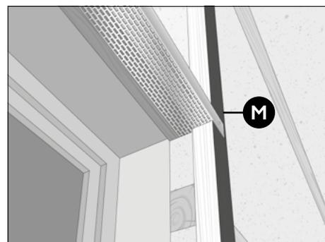
Per mantenere la facciata libera da topi, uccelli, ecc. installare le griglie di ventilazione sul fondo della facciata e sopra le finestre e le porte. Assicurarsi che la fessura più larga di 25 mm sia protetta.
