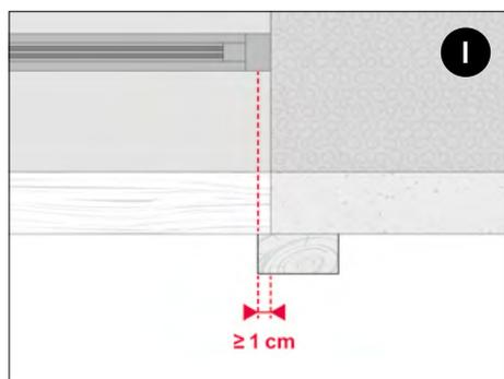
I listelli devono sovrapporsi alle aperture di finestre e porte di almeno 1 cm, a seconda del telaio della finestra e dell'isolamento desiderato.
