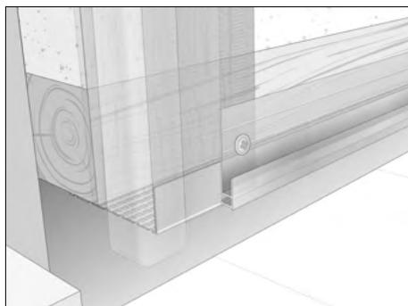
Il profilo di partenza viene installato sul profilo di ventilazione e accanto al profilo angolare.
