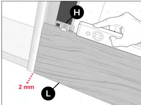
Posizionare la prima doga sul profilo di partenza, mantenendo una distanza di 2 mm. Inserire il bordo inferiore della doga nel profilo. Far scorrere la clip sulla doga. Posizionare una clip per ogni listello.
