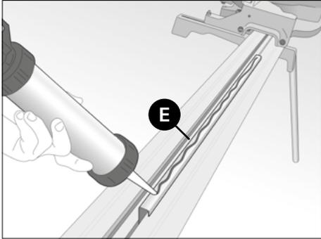
Una volta tagliato, applicare il nastro espanso sulla parte anteriore del profilo di finitura e una linea di colla poliuretanica sul lato del profilo. Applicare il profilo (con colla) sul telaio della finestra, assicurandosi che si allinei perfettamente con il profilo angolare e che non impedisca l'apertura della finestra.
