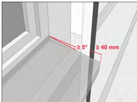
Per un buon risultato, assicurarsi che il davanzale abbia una pendenza di almeno 5°, bordi sollevati lungo ciascun lato di almeno 15 mm e un bordo di sgocciolamento davanti. La profondità del davanzale deve ospitare la cavità, il listello e almeno 40 mm di sbalzo.
