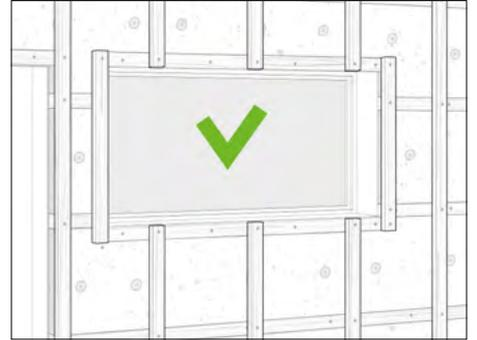
Quando si installano i listelli verticali, controllare ancora una volta che il flusso d'aria non sia ostruito in nessuna parte.
