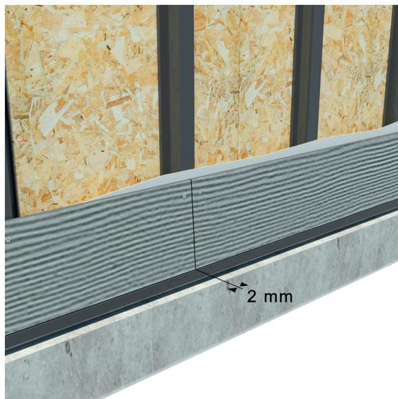
4.4 La instalación de la siguiente hilera de tablas se hace de la misma forma, manteniendo un traslape. Una vez instaladas 3-4 tablas, es recomendable rectificar la horizontalidad de las tablas instaladas.
