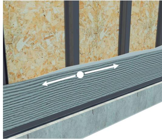
4.3 Todas las juntas deben coincidir con un montante de respaldo. La unión de las tablas en sentido longitudinal, debe ser mínimo de 2 mm como junta de dilatación.
