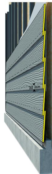
4.5 Se recomienda la instalación de forma trabada (que no exista continuidad de línea vertical entre juntas).
