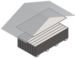
Almacenar en zonas bajo techo, en sentido horizontal sobre una superficie plana, seca y rígida sobre los pallets de fábrica.
