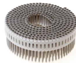
Cedral Lap peut être fixé avec des clous à spirale nervurés en acier inoxydable A2 ou A4 (bande des 0 à 3 km du bord de mer) avec les dimensions suivantes : Ø 2,8 x 45 - 50 mm, diamètre tête 5,5 mm.
