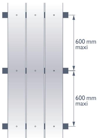
Une fixation centrée est uniquement possible en employant des vis auto-foreuses (auto-perceuses) dont la couleur des têtes (diamètre mini 12 mm) peut être assortie à celle de la lame Cedral Lap.
