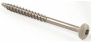
Les lames peuvent être fixées avec des vis à tête bombée en acier inoxydable A2 ou A4 (bande des 0 à 3 km du bord de mer) avec les dimensions suivantes :  $\varnothing 4,2 \times 38$  mm, tête de vis  $\varnothing 8,4$  mm.
