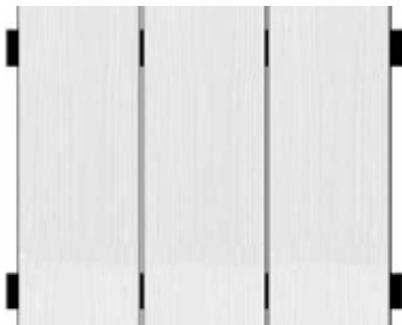
Les lames sont fixées les unes à côté des autres, avec un joint ouvert pouvant aller de 3 à 10 mm. Une lame d'air ventilée toute hauteur de 20 mm mini entre le nu externe de l'isolant ou de la paroi support (en l'absence d'isolant) et la face arrière du réseau d'ossature horizontal supportant la lame Cedral Lap doit être ménagée.
