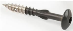
Les lames peuvent être fixées avec des vis auto-foreuse en acier inoxydable A2 ou A4 (bande des 0 à 3 km du bord de mer) avec les dimensions suivantes :  $\varnothing 4,8 \times 38$  mm, tête de vis  $\varnothing 12$  mm.
