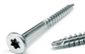
Les lames peuvent être fixées avec des vis à tête fraisée en acier inoxydable A2 ou A4 (bande des 0 à 3 km du bord de mer) avec les dimensions suivantes :  $\varnothing 4,0 \times 45$  mm, tête de vis  $\pm 7,7$  mm.
