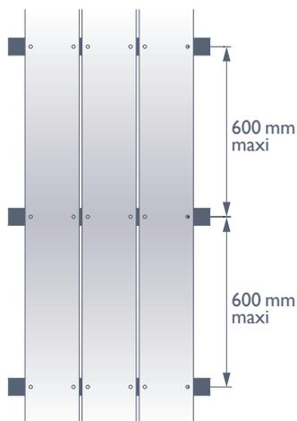
En partie courante des lames, les fixations doivent être positionnée à 600 mm les unes des autres dans la hauteur.
