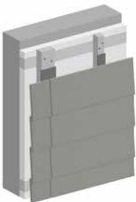
Standardkonstruktion mit vertikaler Traglattung und Dämmstoff zwischen der horizontal angeordneten Konterlattung. Eine zusätzliche Befestigung der Dämmung auf dem Untergrund kann durch Verklebung oder mit Dämmstoffhaltern erfolgen.
