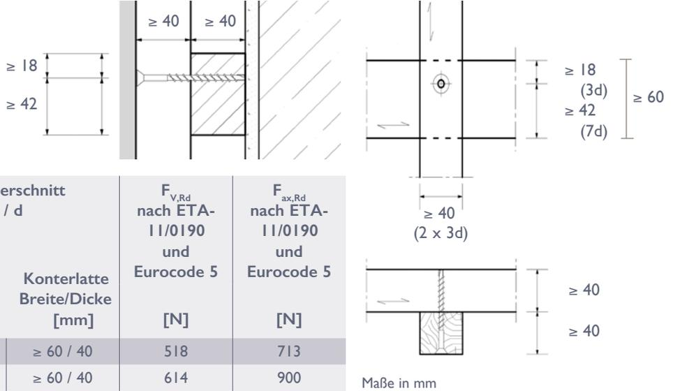
\* Eine Ausführung mit verzinkten, gelb passivierten Schrauben ist ebenfalls möglich.
