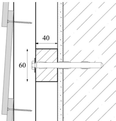
Zur Verankerung der Unterkonstruktion in der tragenden Wand sind bauaufsichtlich zugelassene/bewertete Dübel (Schrauben-Dübel-Kombinationen) zu verwenden. Die Bestimmungen der jeweils gültigen Zulassung/Bewertung sind zu beachten.
