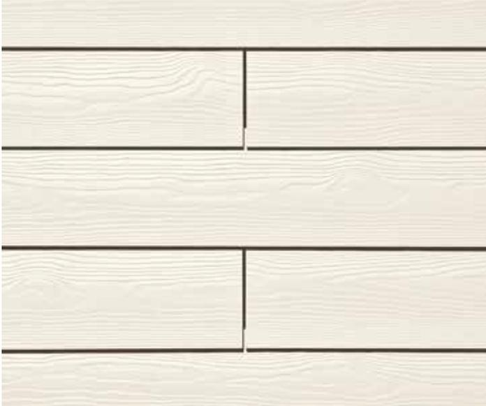
Bei der Verlegung der Fassadenpaneele Cedral Lap als Stülpschalung erfolgt die Verlegung horizontal auf einer vertikal befestigten Traglattung. Die einzelnen vollkantigen Paneele werden übereinander befestigt, wobei das nächste Paneel immer das vorherige um ca. 30 mm überdeckt. Zur Befestigung der Paneele ist die selbstbohrende Cedral Lap Schraube 4,0 x 45 mm (Torx 20) zu verwenden.
