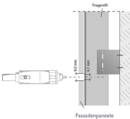
Durch das mit  $\varnothing 9,5$  mm vorgebohrte Fassadenpaneel Cedral werden mithilfe der Bohrlehre die Befestigungslöcher in der Aluminiumunterkonstruktion gebohrt ( $\varnothing 4,1$  mm).
