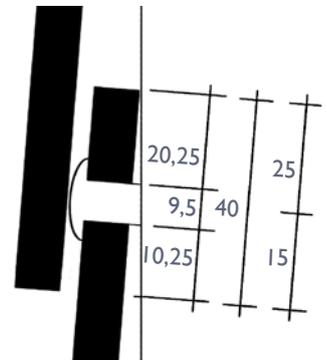
Vertikalschnitt – Abstände und Bohrung; Maße in mm
