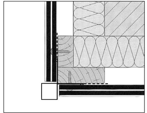
Außenecke mit Eckprofil (Horizontalschnitt)
