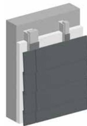
Für größere Dämmstoffdicken kann die vertikale Traglattung durch metallische Winkel- bzw. U-Abstandhalter mit thermischem Trennelement aufgeständert werden (erhältlich von z.B. BWM Fassadensysteme GmbH, Systea Pohl GmbH, GIP GmbH).
