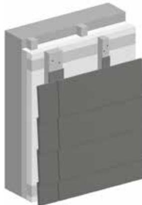
Die 3-lagige Holzunterkonstruktion für Außenwandflächen für eine hinterlüftete Fassadenbekleidung. Die Konstruktion besteht aus einer vertikalen Grundlattung, einer horizontalen Konterlattung sowie einer vertikalen Traglattung.
