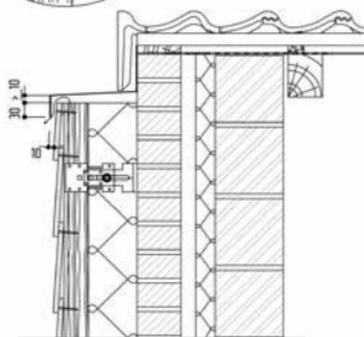
**DÉTAIL 6B** - Rénovation du colmatage entre le revêtement de la façade du pignon et les tuiles faitières au moyen d'un larmier métallique plié.
