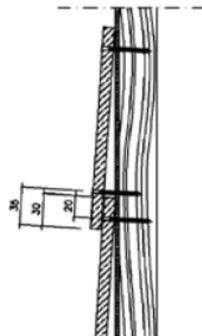
La consommation de matériaux peut être calculée pour une façade continue de Cedral Lap avec un recouvrement de 30 mm et une distance intermédiaire des fixations de 600 mm.
