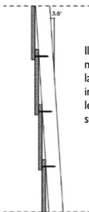
Il est également recommandé de soumettre la paroi à une légère inclinaison (3,6°) pour que les Cedral Lap courbés ne subissent aucune torsion.
