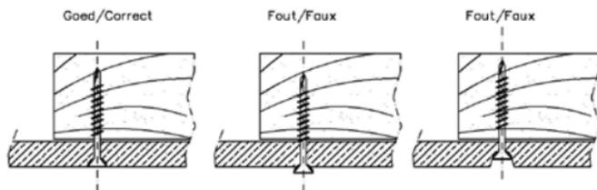
Si les vis sont visibles, il faut utiliser des vis à tête plate bombée. La vis est pourvue d'une pointe perforante, il ne faut dès lors plus préforer les bandes Cedral.
