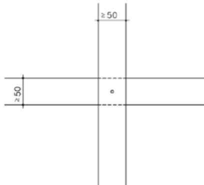
Les extrémités des lattes de support doivent coïncider avec les lattes transversales horizontales.
