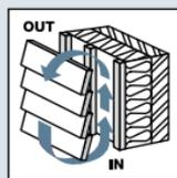
Apposer le revêtement de façade de façon ventilée et ne pas interrompre le flux de ventilation.
