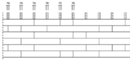
Le montage débute dans le bas de la façade par le placement d'une bande de départ (de la même épaisseur que les Cedral Lap et de la même hauteur que le recouvrement). Cette bande est recouverte par le premier Cedral Lap qui est ainsi placé sous l'angle adéquat ( $4^\circ$ ). Une autre possibilité est de débiter le montage avec un profil de départ en aluminium laqué dans la couleur des Cedral Lap, qui mène à une position correcte du premier Cedral Lap.
