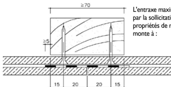
L'entraxe maximal des fixations est déterminé par la sollicitation du vent ainsi que par les propriétés de résistance des Cedral Lap et se monte à :
