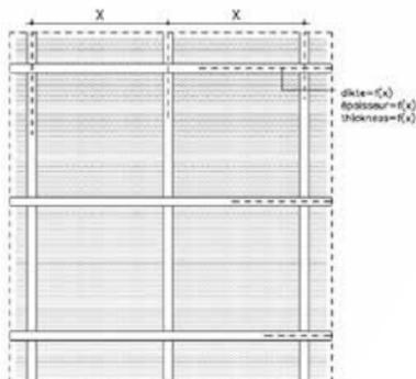
Le montage débute dans le bas de la façade par le placement d'une bande de départ (de la même épaisseur que les Cedral Lap et de la même hauteur que le recouvrement). Cette bande est recouverte par le premier Cedral Lap qui est ainsi placé sous l'angle adéquat (4°).
