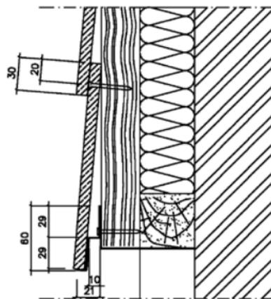
Cedral Lap bride de montage (emballage par 2 pièces) pour simplifier le montage de Cedral Lap posés à clin. Le recouvrement peut être ajusté entre  $\pm 25$  et 40 mm, recouvrement standard est de 30 mm. De cette manière, la partie visible du Cedral Lap peut être adaptée à la hauteur de la façade afin de réaliser un calepinage optimal.
