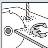
Éliminer immédiatement la poussière de sciage et de forage avec un chiffon en micro-fibres propre.
