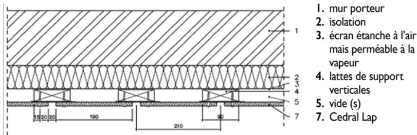
Pour fixer les Cedral Lap une vis en acier inoxydable (qualité A2, AISI 304) à tête bombée colorée avec empreinte TORX T20 peut être utilisée. La vis est pourvue d'ailettes de fraisage le long de sa tige, rendant ainsi superflus les travaux de préperçage.
