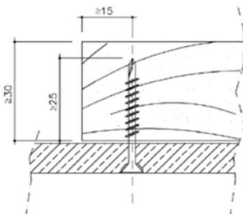
Le vissage des vis se fait au moyen d'une visseuse électrique équipée d'un embout de vissage de haute qualité, adapté au type de tête de vis que vous utilisez.
