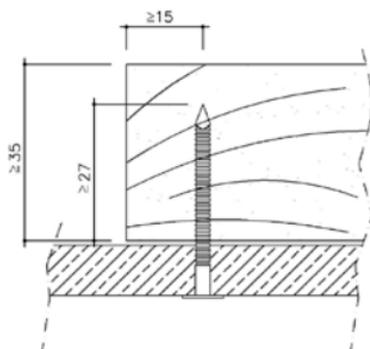
La tête du clou ne peut pas être enfoncée dans le Cedral Lap. La machine de clouage doit être réglée avec chute constante. Si les clous sont enfoncés manuellement, les trous sur les bords verticaux du Cedral Lap doivent faire l'objet d'un perçage préalable d'un diamètre de 2 mm.
