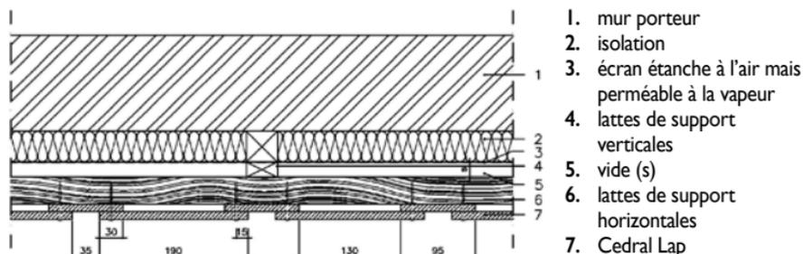
L'entraxe maximal des fixations est déterminé par la sollicitation du vent ainsi que par les propriétés de résistance des Cedral Lap et se monte à :
