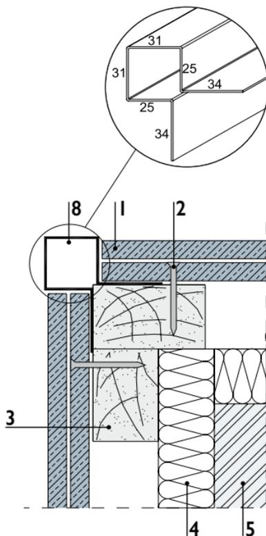
**DÉTAIL IB - Finition d'angle extérieur avec profil en bois**
