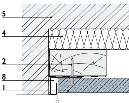
**DÉTAIL 3B - Finition d'angle extérieur avec profil en aluminium**
