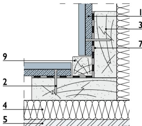
**DÉTAIL 2C - Finition d'angle intérieur avec un onglet**
