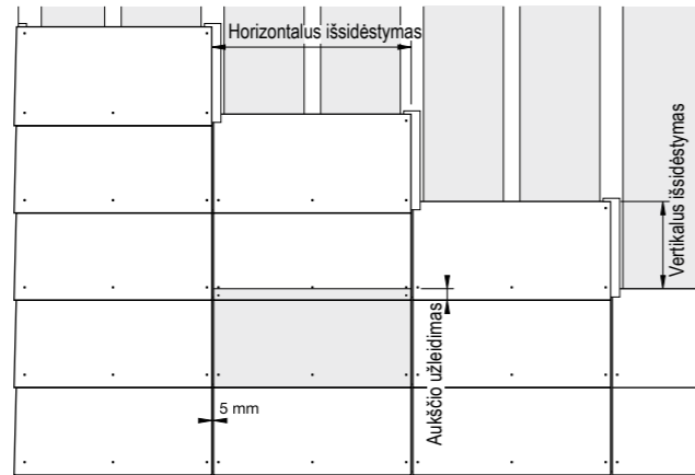
60 x 30 cm fasadinių plokštelių vertikalus dengimas
