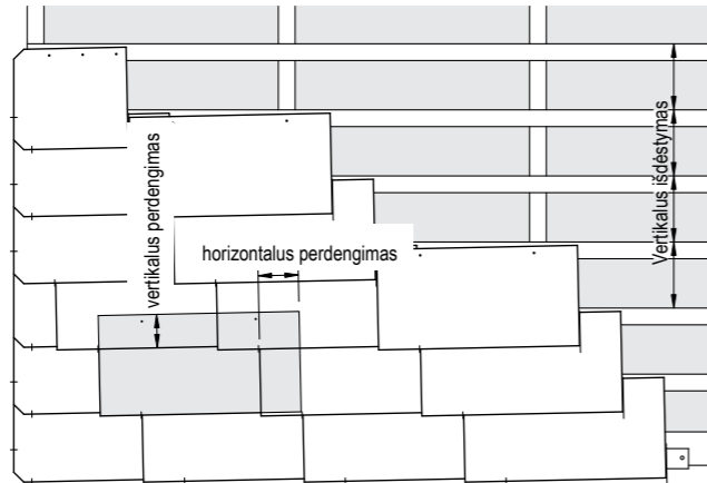
Horizontalus dengimas naudojant 60 x 30 cm formato plokšteles
