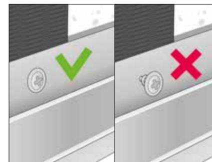
Befestigen Sie das Profil mit den Cedral Lap Schrauben (H). Achten Sie darauf, dass alle Schrauben an der Profiloberfläche anliegen.
