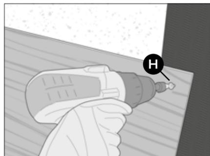
Befestigen Sie die Paneele an jeder Traglattung mit einer Cedral Lap Schraube (H).
