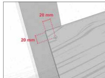
Befestigen Sie die Schrauben 20 mm von der Panelseite und -oberkante entfernt. Schrauben sollen nur anliegen, nicht bündig eingedreht werden.
