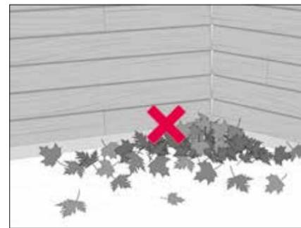
Achten Sie darauf, dass die Belüftung immer offen bleibt. Entfernen Sie z.B. Laub, Schnee und/oder Bodenansammlungen entfernen.
