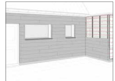
Schneiden Sie die Oberseite des letzten Paneels in Längsrichtung mit der Säge auf die richtige Höhe zu, wobei Sie darauf achten müssen, dass oben an der Fassade ein Mindestabstand von 10 mm für die Hinterlüftung eingehalten wird.
