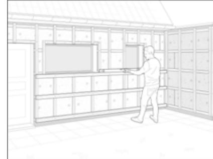
Montieren Sie eine weitere Ebene horizontaler Holzlatten auf die bereits montierten vertikalen Traglatten.
