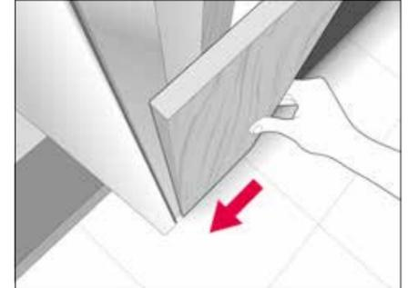
Montieren Sie das erste Paneel in einem Abstand von 2 mm vom bereits montierten Außeneck- oder Leibungsprofil (B).
