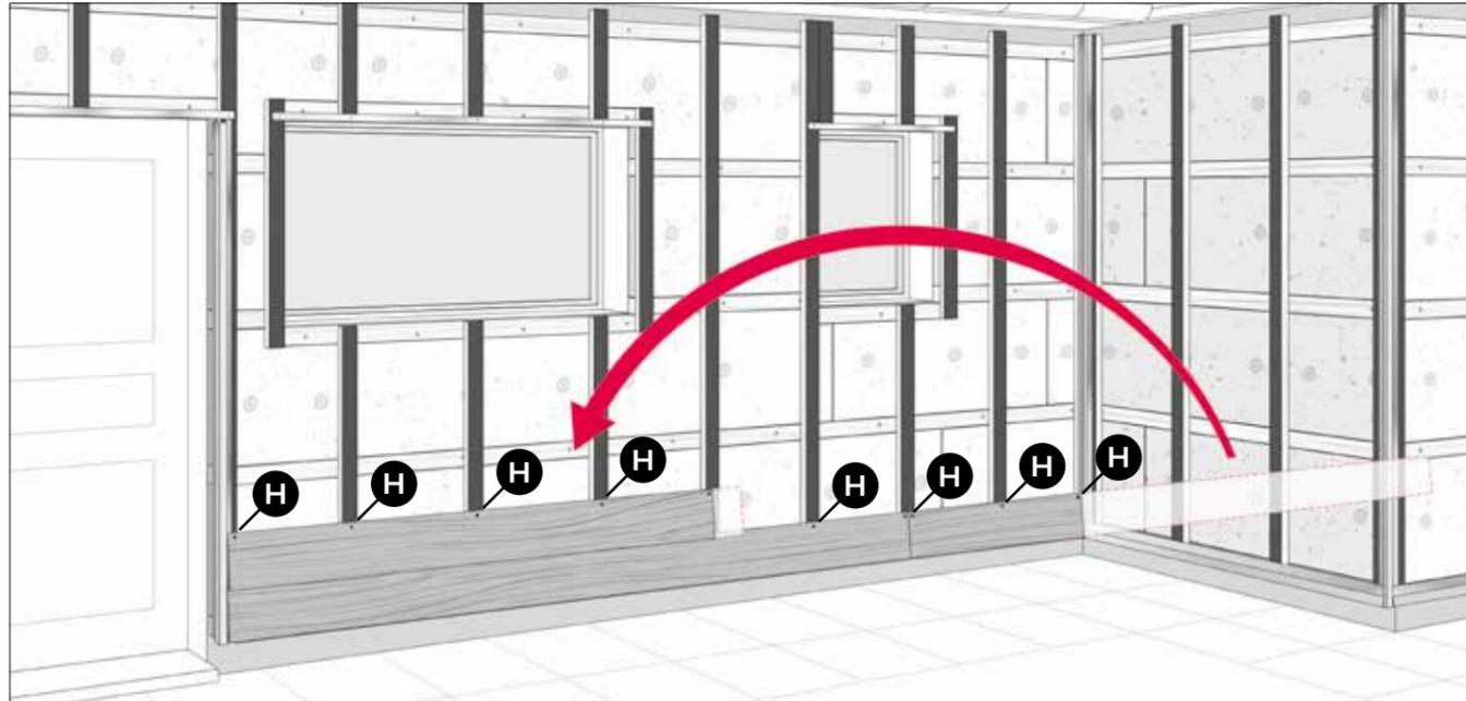
Minimieren Sie Reste. Schneiden Sie den restlichen Teil des Paneels auf Länge. Benutzen Sie den verbleibenden Teil des Paneels, um mit der nächsten Reihe zu beginnen. Achten Sie darauf, dass das Paneelende immer mittig auf einer Holzlattung liegt.
