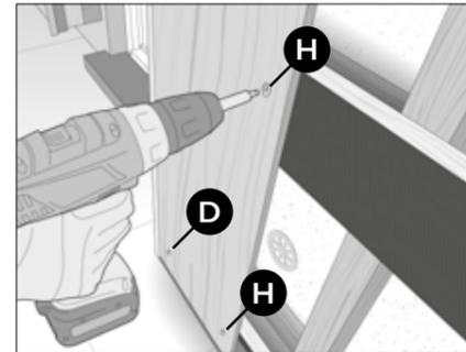
Befestigen Sie die hinteren Paneele zweimal an jeder Traglatte mit mindestens 20 mm Abstand zu den Paneelkanten.
