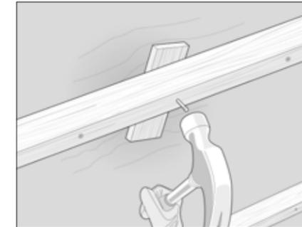
Wenn der Untergrund uneben ist, verwenden Sie Zwischenlagen zwischen dem Untergrund und der Holzlatte, um sicherzustellen, dass diese flächig ausgerichtet ist. Fixieren Sie diese!
