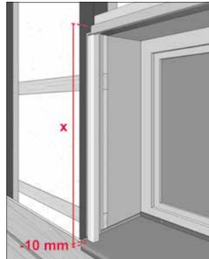
Mit der eingebauten Fensterbank können Sie nun die Länge des Leibungsprofils bestimmen und dabei darauf achten, dass ein Spalt (10 mm) zur Fensterbank verbleibt.
