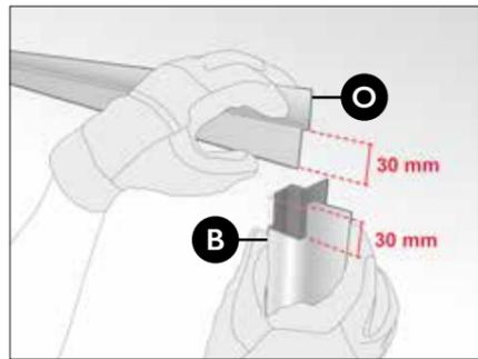
Schneiden Sie das Leibungsprofil (B) zu (Unterkante Sockel bis Oberkante Sturz Tür), um einen sauberen Anschluss zu gewährleisten. Klinken Sie das Leibungsprofil (B) wie im Bild dargestellt aus.
