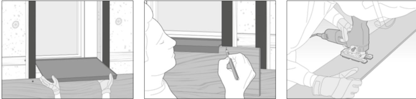
Wenn das letzte Paneel unter dem Fenster fertig gestellt ist, können Sie die Fensterbank anhalten und die Position der Fensterbank auf dem nächsten Paneel markieren. Drehen Sie das Paneel um und zeichnen Sie den Umriss der Fensterbank auf der Rückseite des Paneels nach. Zwischen der Fensterbank und dem Paneel ist ein Abstand von 10 mm für die Hinterlüftung vorzusehen.
