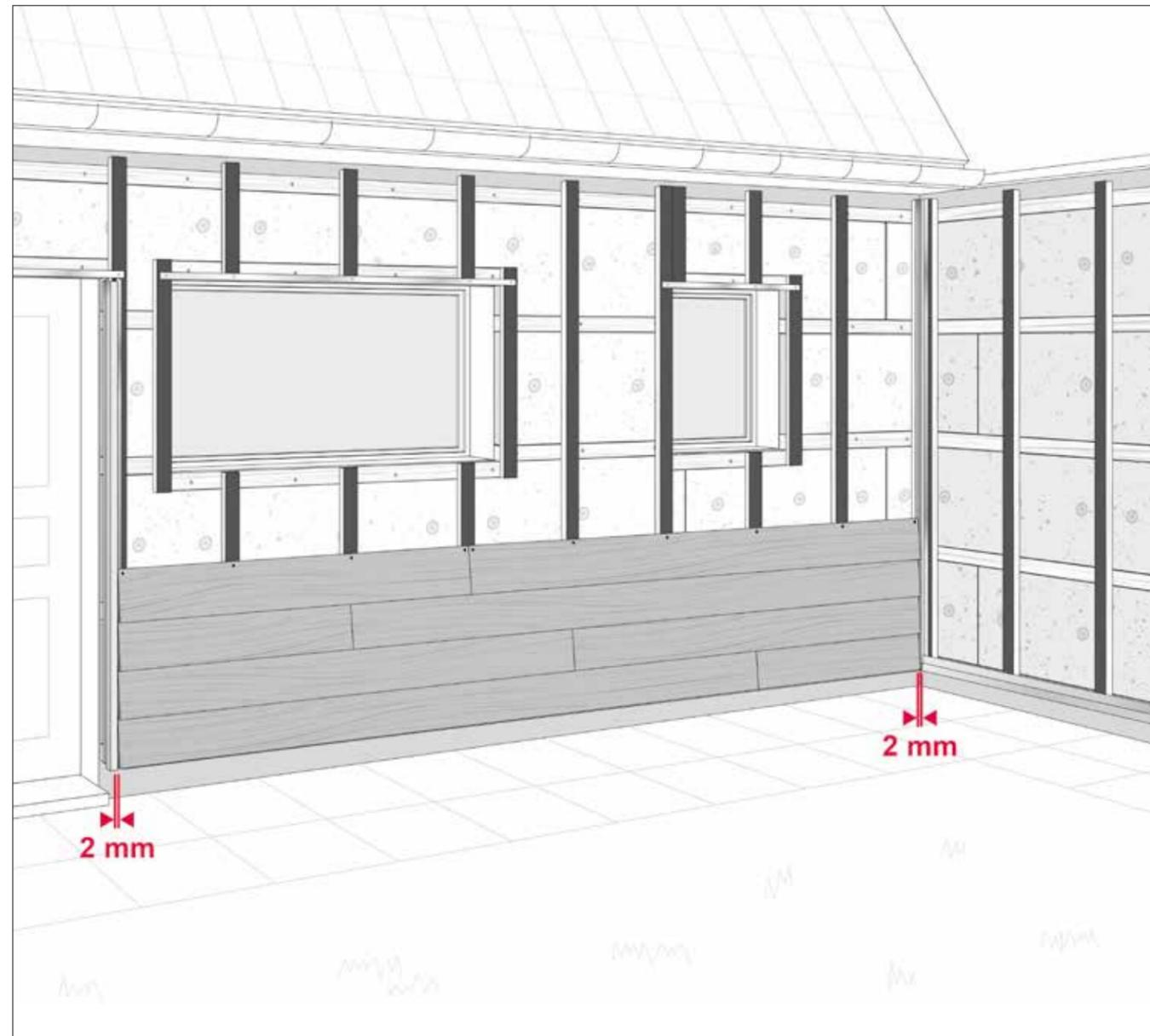
Arbeiten Sie von unten nach oben, montieren Sie die Paneele reihenweise übereinander und schrauben Sie das Paneel an jeder Traglatte fest. Montieren Sie weiter, bis Sie ein Fenster erreichen. Dann verfahren Sie wie auf den folgenden Seiten beschrieben.
