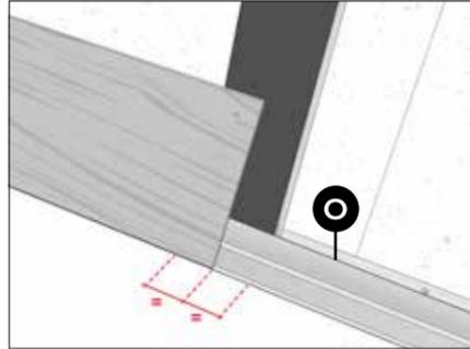
Achten Sie darauf, dass das Paneelende mit der Mitte der vertikalen Holzlatte übereinstimmt. Schneiden Sie dieses ggf. nach.
