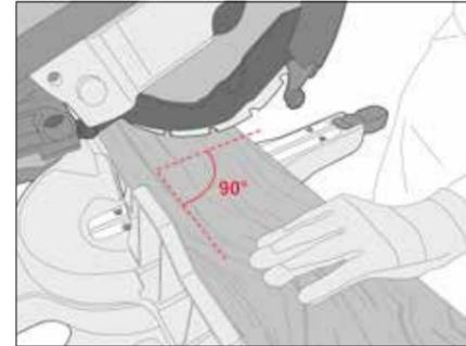
Schneiden Sie das Paneel passend ab. Vergewissern Sie sich, dass es absolut rechtwinklig ist. Tragen Sie beim Schneiden immer Schutzkleidung.
