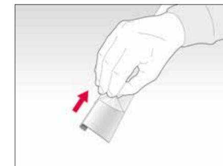
Entfernen Sie vor der Montage die Schutzfolie von den Profilen. Die Pfeile auf der Schutzfolie geben die Beschichtungsrichtung vor. Bei Profilstößen bitte auf gleiche Pfeilrichtung achten.
