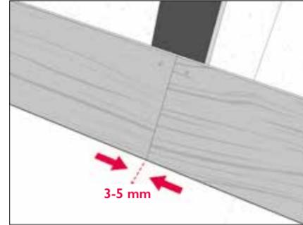
Nächstes Paneel montieren. Legen Sie das nächste Paneel neben das vorherige Paneel und immer auf eine darunter liegende Traglatte. Dabei wird eine Fuge von 3-5 mm empfohlen.
