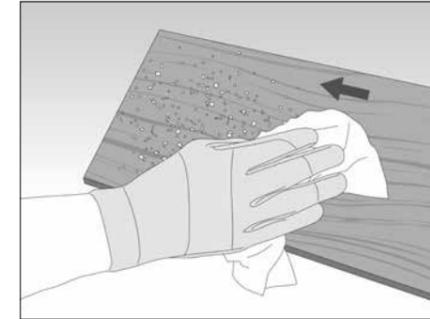
Nach dem Schneiden den Schneidstaub mit einem Mikrofasertuch von der Oberfläche und der Paneelkante entfernen.
