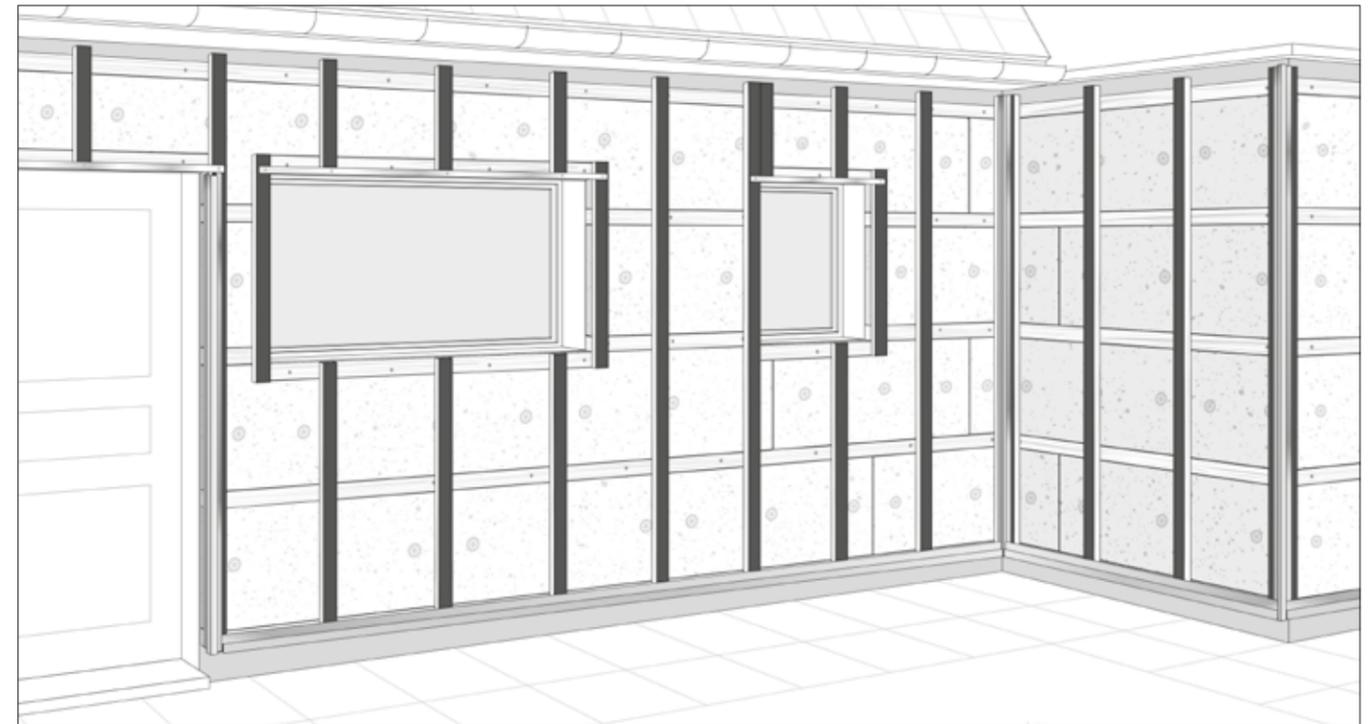
Vor der Montage der Cedral Paneele ist zu prüfen, ob das Starterprofil (O) waagrecht ist und überall auf gleicher Höhe beginnt. Überprüfen Sie auch, ob die Hinterlüftung ungehindert bleibt.
