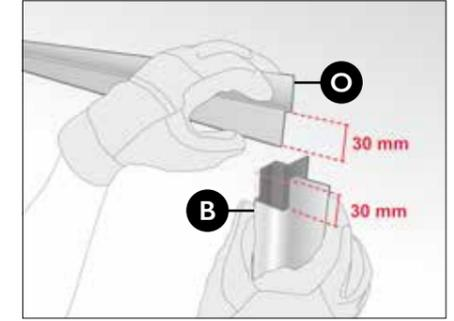
Schneiden Sie das Leibungsprofil (B) auf Länge ab. Lassen Sie dabei einen Spalt von 10 mm zur Fensterbank. Die seitliche Aufkantung der Fensterbank muss in das Leibungsprofil eingeschnitten werden.
