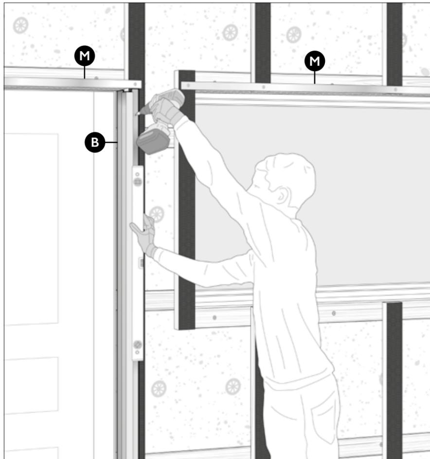
Befestigen Sie nun das Leibungsprofil (B) mit der Cedral Schraube (H) an den Holzlatten. Bohren Sie die Profile ggf. mit 4 mm vor.
