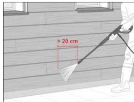
Alternativ kann ein Hochdruckreiniger mit einem maximalen Druck von 80 bar und einem Mindestabstand von 20 cm zur Bekleidung eingesetzt werden. Rotierende Düsen sind nicht geeignet.
