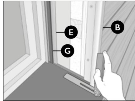
Nach dem Zuschneiden des Leibungsprofils (B) wird ein Polyurethan-Kleber oder ein Schaumstoffstreifen (G) auf die Vorderseite des Fensteranschlussprofils (E) aufgetragen. Auf der Innenseite des Fensteranschlussprofils (E) wird ein Schaumstoffstreifen (G) angebracht. Das Fensteranschlussprofil (E) wird fluchtgerecht am Leibungsprofil (B) ausgerichtet, am Fensterrahmen angedrückt und seitlich verschraubt.
