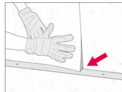
Bei der Verwendung von horizontalen Holzlatten, wie oben beschrieben, bestimmt die Lattendicke die Dämmstoffdicke.
