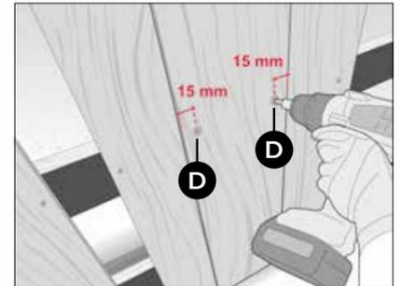
Positionieren Sie die Deckelpaneele mit 30 mm Überlappung zu den hinteren Paneelen. Die vorgebohrten Deckelpaneele mit farbigen Cedral Schrauben (D) mit einem Randabstand von 15 mm befestigen. Die Schraube muss beide Paneele durchdringen und 25 mm in das Holz eindringen.
