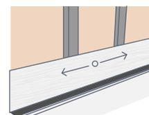
4.3 Todas las juntas deben coincidir con un montante de respaldo. La unión de las tablas en sentido longitudinal, debe ser mínimo de 2 mm como junta de dilatación.
