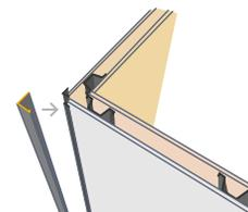
5.2 En caso de que la última hilera de tablas quede a la interperie, debe disponerse un cierre que se puede ejecutar con el perfil J o una pieza galvanizada en forma de L.
