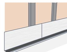
4.4 La instalación de la siguiente hilera de tablas se hace de la misma forma, manteniendo un traslado. Una vez instaladas 3-4 tablas, es recomendable rectificar la horizontabilidad de las tablas instaladas.
