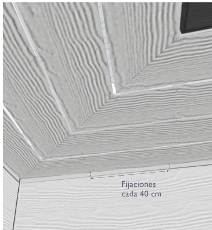
Para la instalación de aleros y tapacanes, se debe confeccionar una sub estructura para instalar esta puede ser en madera o acero galvanizado, esta sub estructura debe considerar un perfil cada 40 cm en sentido trasversal al largo de la tabla.
